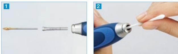
A negligência na limpeza do porta-fresas durante um longo tempo é muito perigosa, porque elementos como graxa, gesso, entre outros, podem penetrar dentro do porta-fresas e sua presença pode causar uma contenção insegura da fresa, produzindo rotação descentralizada. A fim de minimizar o risco causado pelo mau funcionamento do portafresas, realize sua manutenção regularmente como explicado a seguir.
