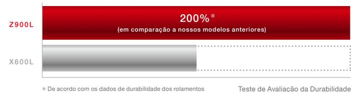
Nós reprojetoamos completamente a forma e encontramos materiais melhores para o retentor de rolamento a fim de reduzir a resistência friccional e desenvolvemos um novo tipo de rolamento que oferece quase o dobro da durabilidade para acomodar uso constante de termodesinfetante e autoclave.
